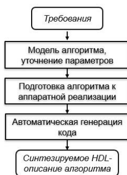
Рисунок 1. Этапы разработки при модельно-ориентированном проектировании.
